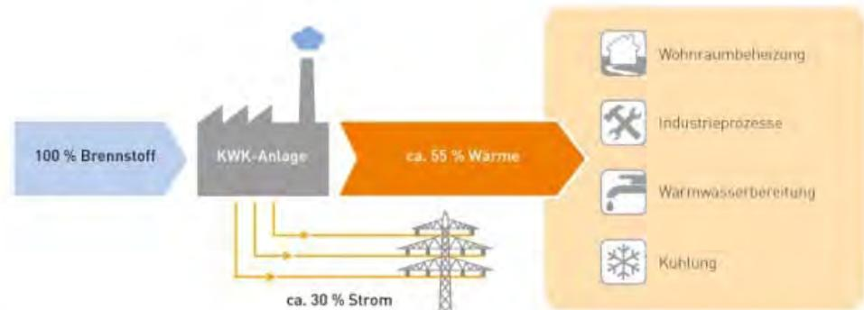
Bei Kraftwerken mit Kraft-Wärme-Kopplung wird der Energiegehalt des Brennstoffs zu mehr als 80 % in nutzbaren Strom und nutzbare Wärme umgewandelt.
